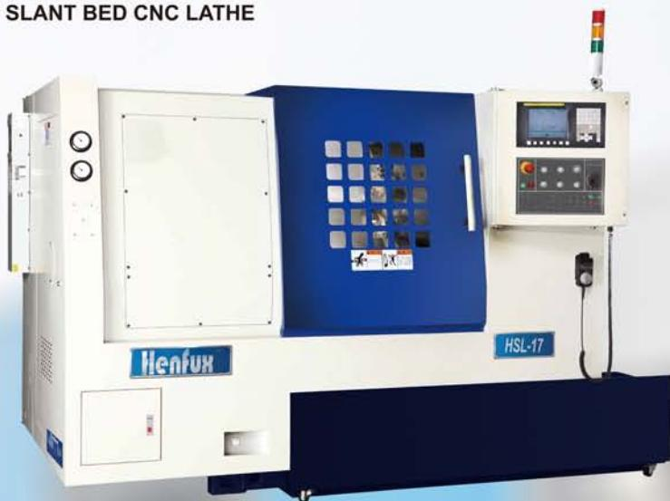
HSL-17 系列 CNC 數控斜背臥式車床，強化肋箱型設計，以米漢納鑄鐵鑄造確保機臺高剛性與穩定性以及機臺質量與使用壽命。高剛性機臺搭配 A2-6 主軸 (通孔 Ø62mm / 棒材通孔 Ø52mm / 4500rpm)、8 英寸油壓夾頭以及 11KW(15HP) 主軸馬達，可輕鬆進行單邊 5mm 切削深度之重切削作業，縮短加工時間。全密式鋁金與大型工作滑門提供足夠的操作空間以及確保操作安全性。
